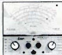
VOLTMETRO ELETTRONICO MOD. A.V.O. 7/E
